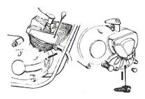
Ogni 1000 Km. controllare il livello dell'olio nel cambio che, con il motociclo in piano e giù dal cavalletto, deve essere compreso tra le due tacche segnate nell'astina di livello quando il tappo è completamente avvitato.
